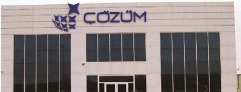
Yarı kapaklı cephe sistemi, kompozit panel, fotosel kapı, alüminyum doğrama
